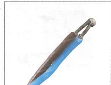
Un thermocouple est composé de deux fils de métaux différents raccordés à chacune de leurs extrémités. Lorsqu'une de ces extrémités est chauffée, il se produit alors un courant continu. On l'emploie notamment dans les sondes thermiques.
