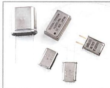
Un piézoélectrique est un dispositif qui produit de l'électricité sous l'action d'une contrainte de compression. On en trouve souvent dans les montres.
